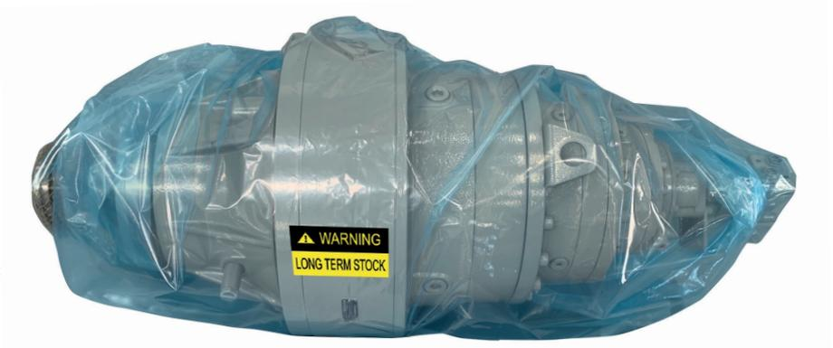
All'interno del sacco VpCI, un cartellino **“ATTENZIONE\_STOCK LUNGO PERIODO”**, legato ad un cordino, sarà visibile sulla superficie del riduttore:
