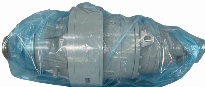
L'unità imballata all'interno di un VpCI è identificata da una specifica etichetta adesiva **“AVVERTENZA STOCK LUNGO PERIODO”** posta sulla superficie esterna del sacco VpCI.
